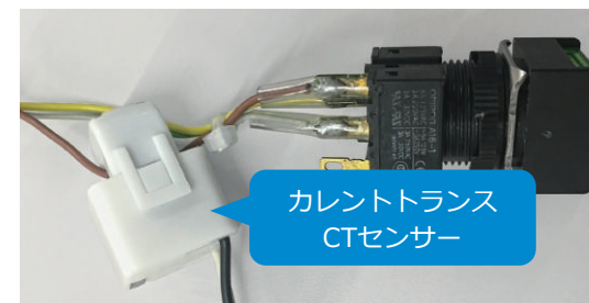
▲稼働信号配線に電流センサーをクランプするだけ
